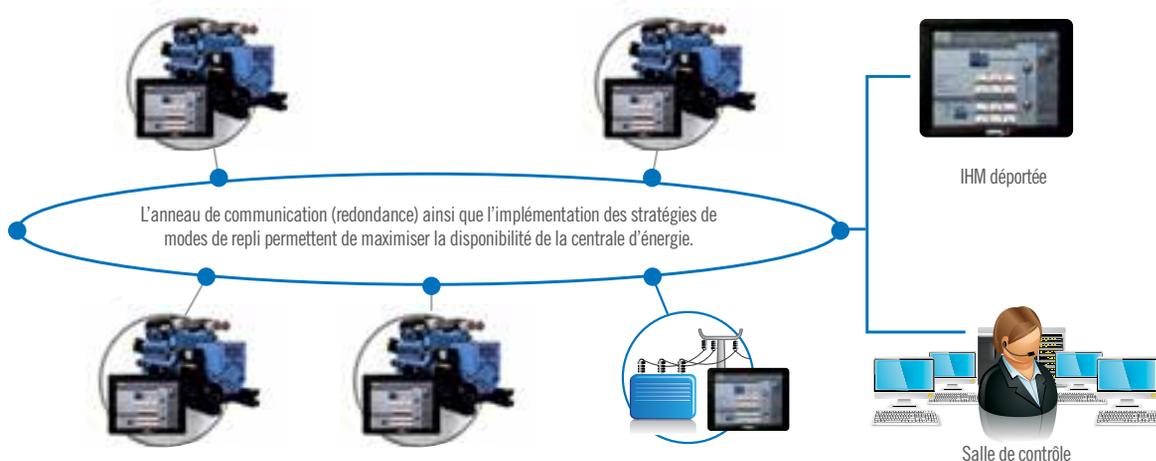
L'anneau est réalisé par plusieurs segments Ethernet et concentre les communications automatisme et régulation. L'APM802 peut être intégré en pupitre, en coffret embarqué, directement sur le groupe électrogène, ou en armoire séparée, pour s'adapter à toutes les contraintes d'installation. Gage d'innovation, l'APM802 est protégé par des Copyrights et deux brevets.
