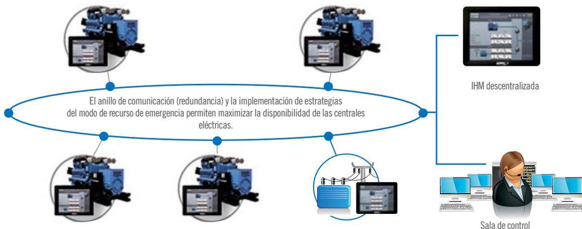
El anillo está formado por varios segmentos Ethernet y concentra las comunicaciones de automatismo y regulación. La unidad APM802 puede incluirse en una consola central, en una unidad de control integrada, directamente en el grupo electrógeno o en un armario aparte, para adaptarse a todas las limitaciones de la instalación. El APM802 es un sistema innovador protegido por copyrights y dos patentes.
